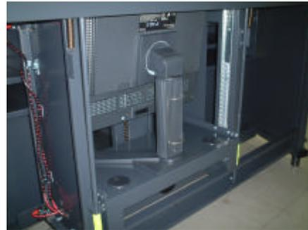
図2 ディスプレイ電動昇降機
