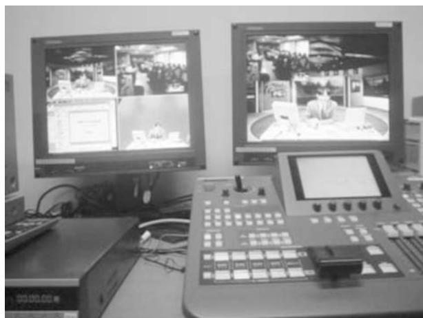
図4 パーチャルスタジオシステムによるリアルタイム映像画面合成
