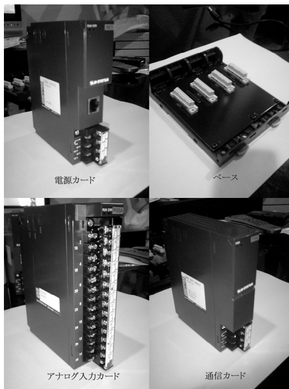
図6 M-SYSTEM リモート I/O 機器類の各種カードの実装の様子
