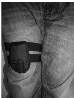
図3 しゃがむ姿勢の検出用 SunSPOT の取り付け具
