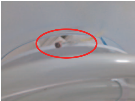
図6 照明に設置したCdSセル
