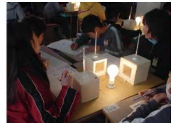
日射取得・断熱・蓄熱の模型実験
