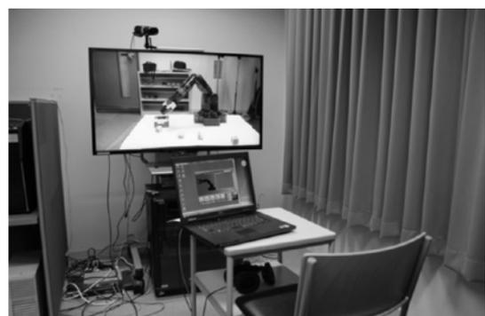
写真 2 3D 立体視映像を用いた遠隔操作端末
