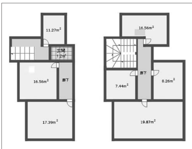
図7 2階建て教室延床面積97.35m 2 の間取り
