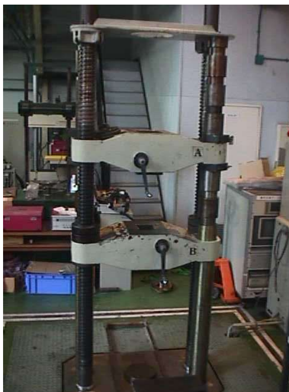
写真 4-2 アムスラー型 100t 万能試験機
