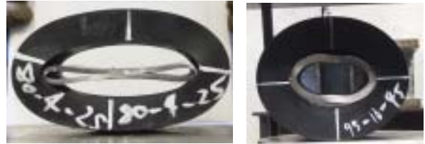
(a) 80×4 ゴム 25mm (b) 95×10 ゴム 45mm 図-28 衝撃荷重載荷後の試験体
