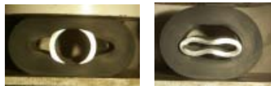
(a) 変形量 70mm (b) 実験終了後 図-4 ゴム鋼タイプの緩衝材(R-95, tp10-tr45)の変位形状の推移
