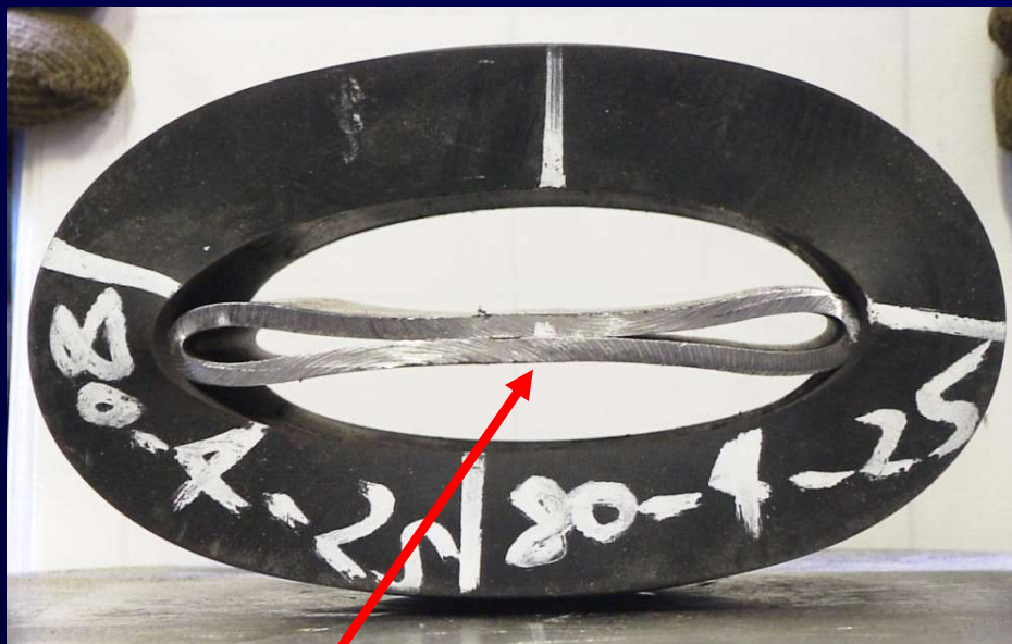
鋼管80×4 ゴム厚25mm
