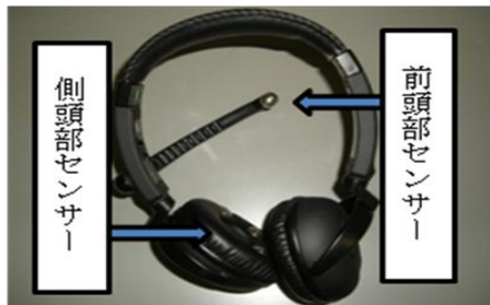
写真-1 脳波測定器 (NeuroSky 社製 MindSet)
