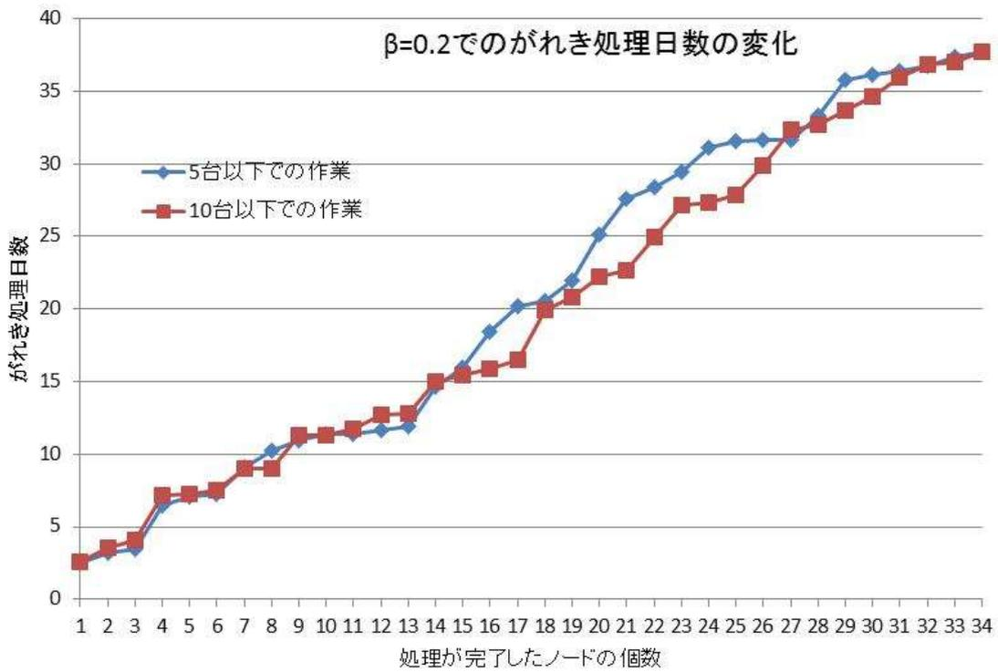
図-5-12 βの変化によるがれき処理過程の変化
