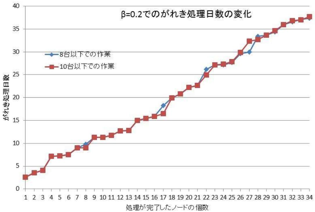
図-5-18 β の変化によるがれき処理過程の変化
