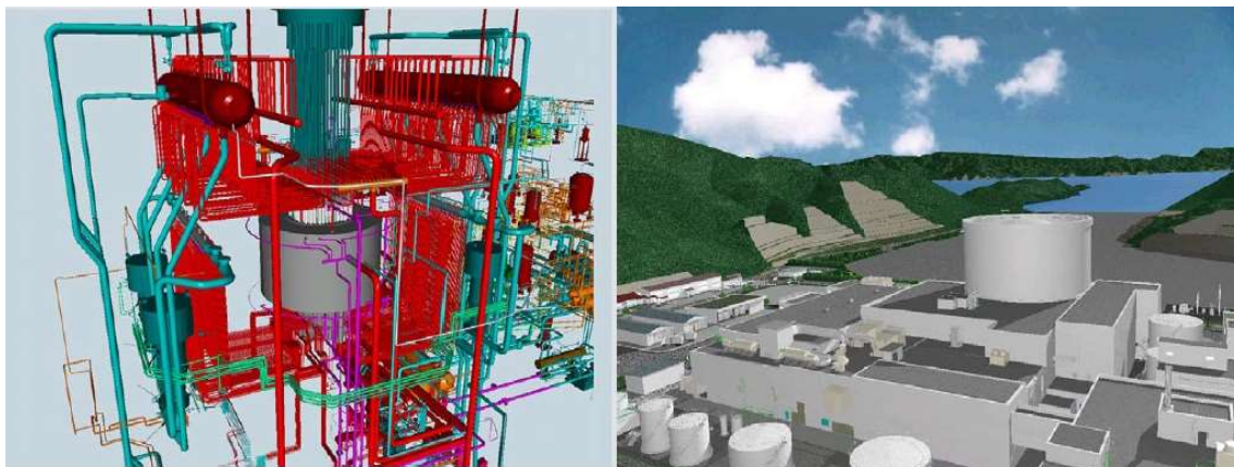
図-14 独立行政法人 日本原子力研究開発機構 ふげん発電所廃止処置による解体シミュレーション
