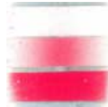
図-12 感圧紙の実験結果 上から中圧用、低圧用、超低圧用
