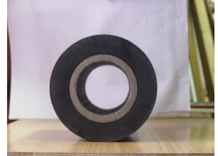
写真1 ゴム鋼併用型緩衝材
