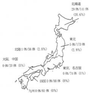
(A) 亀裂の発生した地域
