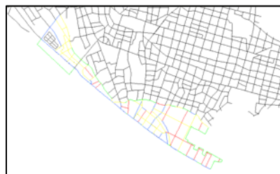
図-3 Civil3Dによる幅員線
