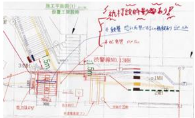
図-11 仮覆工架設時における鉄管発見時の記録
