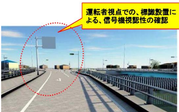
図-14 交差点形状、標識設置位置の確認 9)
