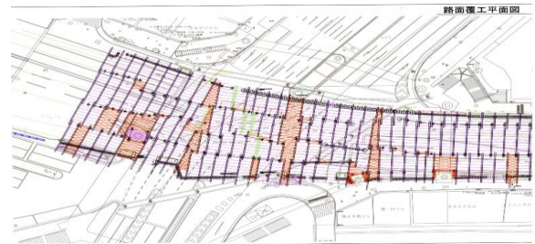
図-3 路面覆工図の一部
