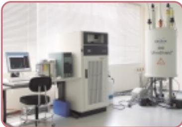
エネルギー環境科学研究センターが取り組むテーマのひとつが、燃料電池の開発。この「核磁気共鳴装置AVANCE400システム」は、燃料電池を構成する電解質膜や電極触媒、半導体や増感剤などの構造を解明するために役立ちます。
