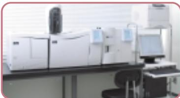
「ガスクロマトグラフ質量分析計Turbo Mass Gold」。燃料電池の電極で起こる反応や、光触媒で有害物質を分解するとき生じる特定のガスを精密に分析できる装置です。電池の性能向上や、最適な触媒の製造を手助けします。
