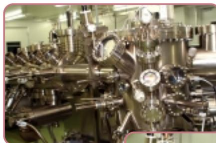
より高性能なデバイスを開発するためには、極めて真空度の高い状態で結晶を作製する必要があります。この「シリコン系分子線エビタキシー装置」は原子レベルで結晶をコントロールできる最先端の装置です。
