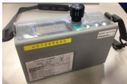
写真 1 デジタル粉塵計 LD-3C 型
