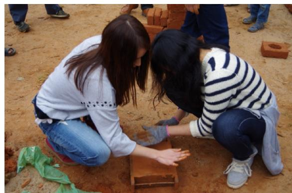
型から形を崩さずに出すため、角を地面にたたきつけて、隙間を作ります。粘土が動くのを目で見てわかるようになるのが目安です。取り出すと
