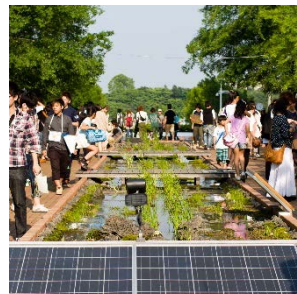
中庭に設置した湿地型バイオパッケージ
