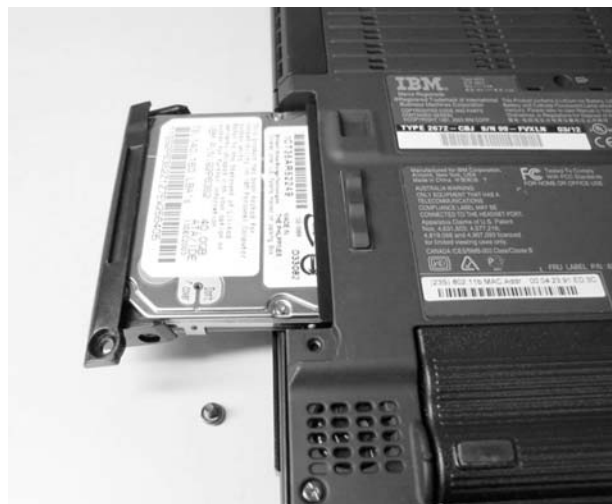
図4 本体を裏返しにして、脇のネジを一本外すとハードディスクが引き出せる。押し込むだけで接続が完了する。IBM ThinkPad X31。
