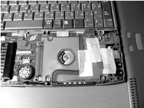
図5 HDD を包む薄い金属の箱の上に二本のフレキシケーブルがテープで止められている。ケーブルの片端の端子を外しテープも剥がすと、箱ごと HDD を抜き取れる。
