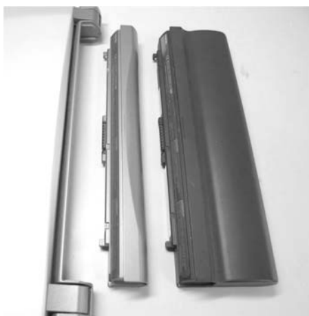
図2 東芝 DynaBook SS とそのバッテリーを示す。左から本体、標準バッテリー、Libretto L 用の3倍バッテリー。バッテリーはLibretto L シリーズと互換性がある。
