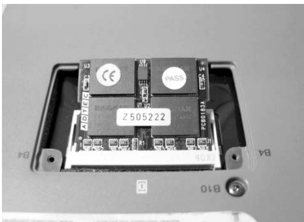
図3 本体底のメモリ増設ふたをあけてソケットにMicroDIMMをあてがったところ。モジュール上端を押し込んで完全に固定されたら再びふたを閉める。
