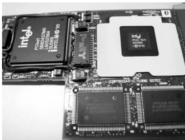
図 1 1997 年頃のノートパソコン用 CPU モジュール。右上が基盤に直づけされた Intel Pentium-133 プロセッサ。その左の大きめのがメモリアクセスなどをつかさどるノースブリッジ。下に二つ並んでいるのが二次キャッシュメモリ。この頃のものを今実用にするのはさすがに無理。
