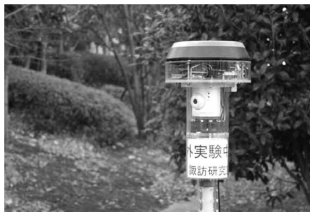
図1 フィールドサーバの外観
