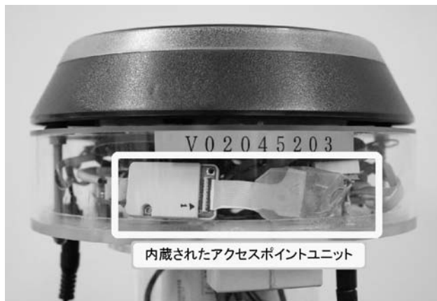
図9 フィールドサーバに内蔵したワイヤレスセンサノードのアクセスポイント
