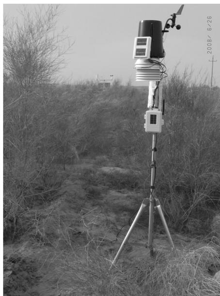
図8 現地試験地への気象装置の設置状況
