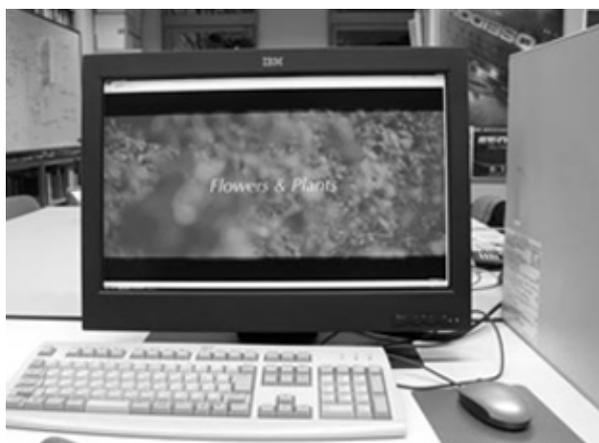
図3 IBM 22.2型モニタ T221 を用いた4K画像システム
