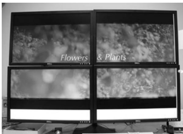
図2 4面マルチディスプレイ型4K画像システム
