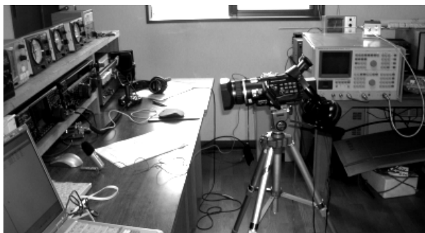
図5 実験結果の記録方法(デジタルビデオカメラを使いスペアナ表示と漏洩雑音の両方を同時に記録)
