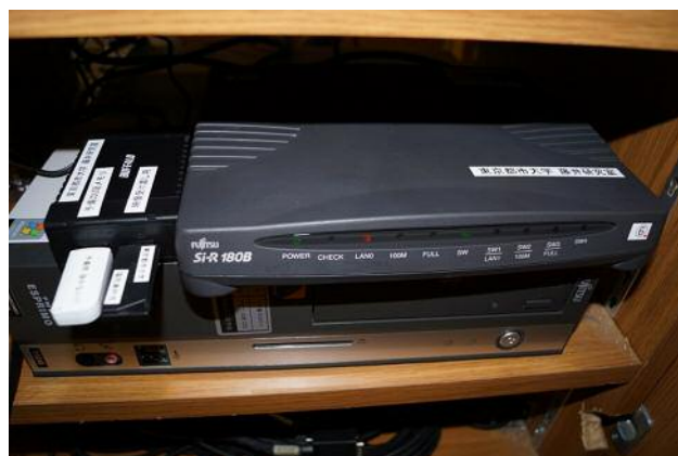
図6 塩尻高校に設置されたVPNルータ（右）とUSBサーバー（左）。USBサーバーにはUSBメモリが刺さっている。
