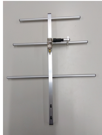
図 3.6 八木宇田アンテナ調整前
