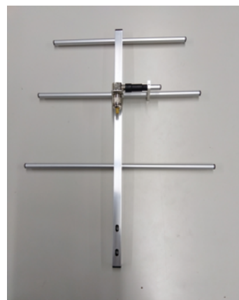
図 3.8 八木宇田アンテナ調整後
