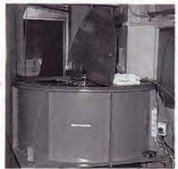
▲遠心模型実験装置(カメラ内蔵) 地滑りの様子を再現する
