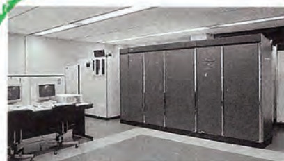
▲情報処理センターの心臓部 スーパーコンピュータFUJITSU-VP2100（主記憶256MB）
