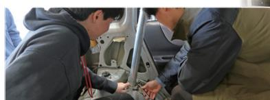
内装をはがして、安全を守るロールバーを取り付けているところ。コストを削減するために、鉄パイプを切り出して自作します。
