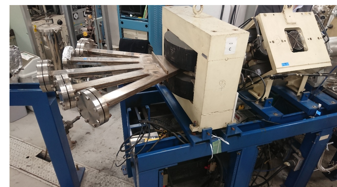
ビームラインの増強を計画(集束電磁石と振分電磁石を追加)
