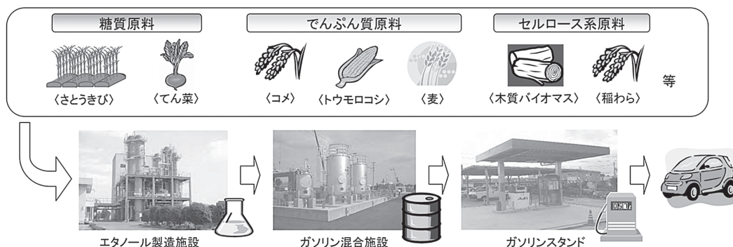
図3 バイオエタノールの製造と燃料利用
