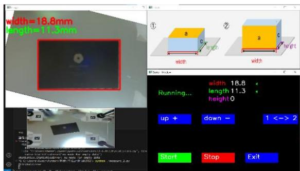
図 1：寸法計測実行画面
