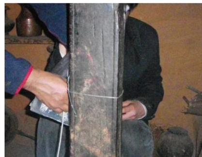
写真 1 : 計測器設置 (写真の通り、すべてビニールの中で装置を保護し固定する。)
