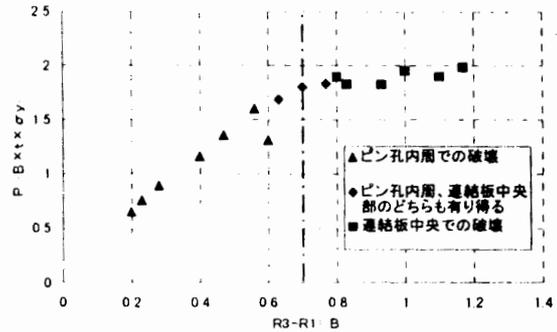
図-3 耐荷力と $(R_3-R_1)/B$ の関係
