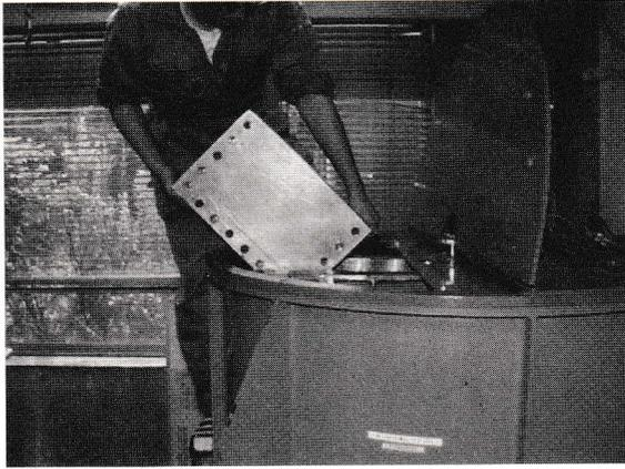
写真一：小型遠心荷重装置内に模型地盤を設置しようとしているところ。模型と実物の相似率を合わせるために回転によって加速度50G程度に上げる。その遠心力により応力を大きくした後に荷重実験を行う。
