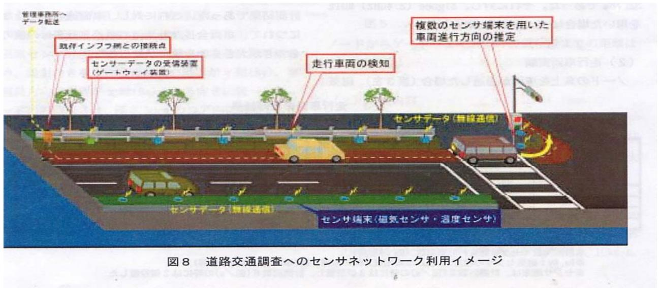
図8 道路交通調査へのセンサネットワーク利用イメージ
