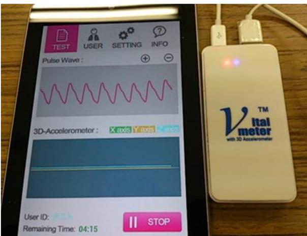
写真-1 生体脈波測定器具 (Vital meter)
