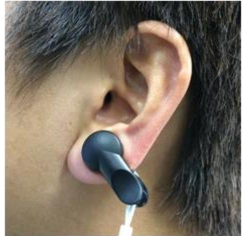
写真-2 脈波測定器装着時の様子
