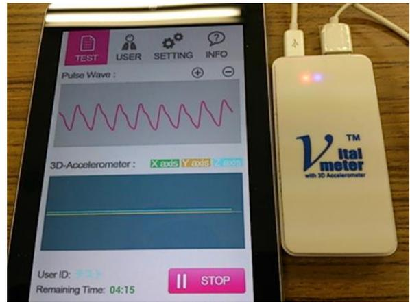
写真-1 生体脈波測定器具(Vital meter)
