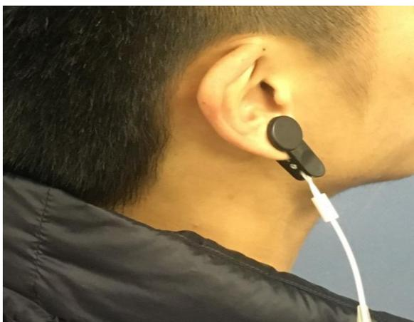
写真-2 脈波測定器装着時
